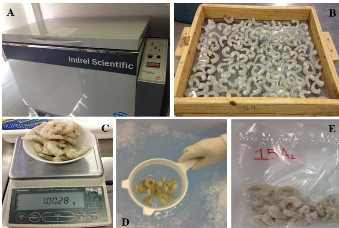
**Figura 7** - A) Ultrafreezer com temperatura ajustada para  $-30^{\circ}\text{C}$ ; B) Camarões dispostos individualmente em bandeja para congelamento; C) Pesagem do camarão congelado em amostras de 100g; D) Imersão do camarão congelado em água gelada ( $0\pm 1^{\circ}\text{C}$ ); E) Amostra de camarão glaciado embalada a vácuo. Fonte: Arquivo Pessoal.
