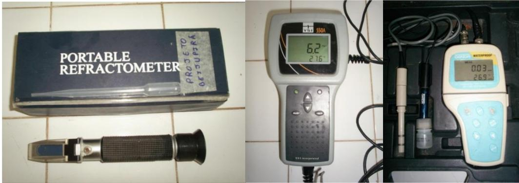
Figura 4 - Equipamentos usados durante o experimento: Da esquerda para a direita: refratômetro, oxigêniometro, pHgâmetro/potenciômetro e condutivímetro.
